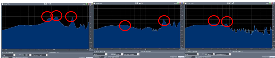
그림 77 ‘아’ 발음 성도 모형 공명관의 응답 특성 그림 78 ‘이’ 발음 성도 모형 공명관의 응답 특성 그림 79 ‘우’ 발음 성도 모형 공명관의 응답 특성
