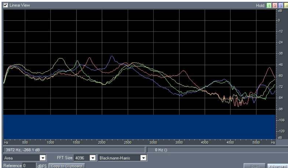
그림 85 스티로폼 원통의 위치에 따른 가변형 관 모형의 응답 특성(초록:0cm, 분홍:2cm, 보라:4cm, 노랑:6cm)
