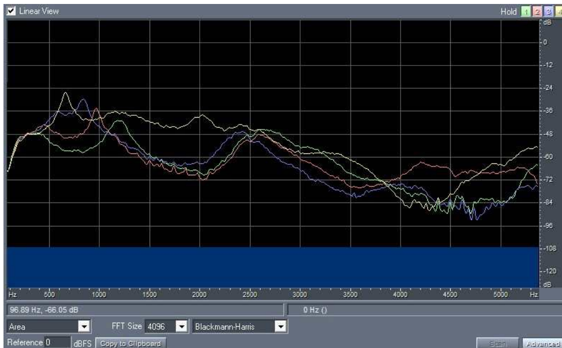
그림 86 스티로폼 원통의 위치에 따른 가변형 관 모형의 응답 특성(초록:6cm, 분홍:8cm, 보라:10cm, 노랑:12cm)
